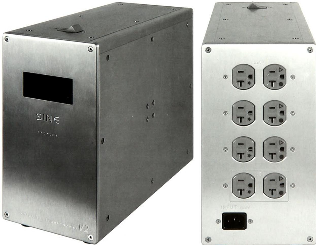
SINE所用的是環形隔離牛，由上一代產品改良優化而來，鐵芯採用了更薄的矽（硅）鋼片，磁滯和鐵損更低，繞組則採用了純度更高的漆皮線，令綜合效率提高了一成以上。
